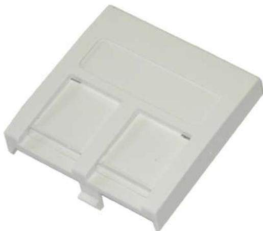
Clip 45x45 duplo plano com suporte para módulos RJ45. Para instalação em caixas ou suportes 45x45 de qualquer fabricante. Para módulos RJ45 tipo Keystone e Systimax. Amplo espaço de etiquetagem. Também disponível em versão simples para 1 módulo RJ45 e em versão sem tampa. Disponível em RAL 9010 e RAL9003.
