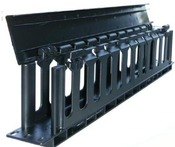
Organizador horizontal de cabos de 1U e tampa plástica para encaminhamento de cordões de patching mantendo o aspecto arrumado do bastidor. Construção em PC-ABS V0 com um acabamento perfeito, sem arestas, protegendo os cabos. Base com duas aberturas que permitem o encaminhamento de cabos para a traseira do painel. Tampa com efeito dobradiça em cima e em baixo, permitindo o acesso aos cabos sem remover a tampa. Disponível também em 2U.
