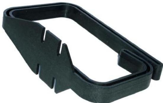
Organizador vertical para encaminhamento de cabos em racks de 800mm de largura. Construção em material termoplástico de alta flexibilidade e resistência, assegurando a protecção dos cabos. Instalação simplificada utilizando a furação lateral dos perfis de 19". Cada argola possui 4 furos espaçados em 25mm na horizontal e vertical, permitindo a sua utilização em racks de diversos fabricantes.
